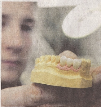
So sieht Zahnersatz aus, der nach einer digitalen Vorlage aus einem Vollkeramikblock gefräst wurde.
